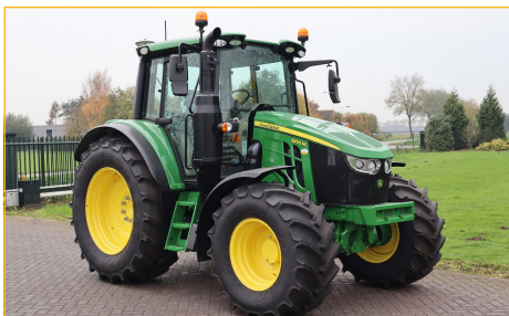
John Deere 6100M, nieuw/demo, 70 uur, Autoquad 24/24 40 km/u, banden 600/65R38 en 540/65R24, lucht- en hydr. geremd
