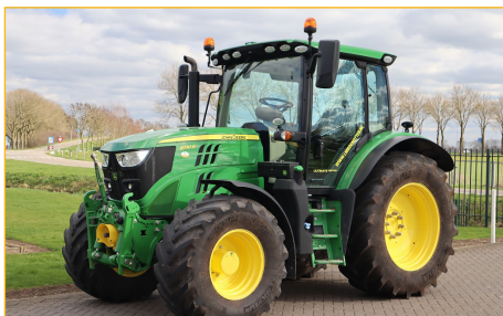
John Deere 6130R, BJ 2021, 2150 uur, Autopower 50 km/u, banden 600/65R38 en 540/65R24, Autotrac, fronthef met PTO
