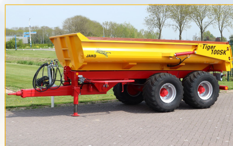
Jako Tiger 100 kipper, laadvermogen 10 ton, tandemas luchtgeremd, dissilvering, hydraulisch achterbord, nieuw
