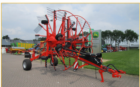
Kuhn GA8731+ hark, werkbreedte 8.70 mtr, eenzijdig uitheffen, 13 tandarmen per rotor, nieuw uit voorraad leverbaar!
