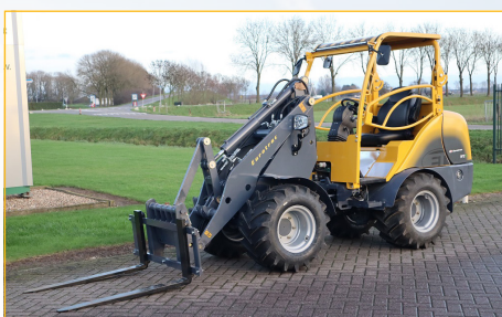
Eurotrac W12S kniklader, banden 31x15, 50-15AS, compleet met bak en palletlepels
