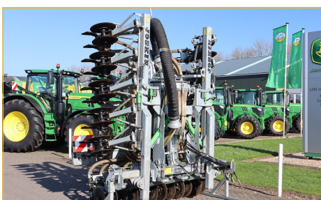
Joskin Solodisc 6880 bemester, BJ 2018, werkbreedte 6.88 mtr, hydraulische voetafsluiters
